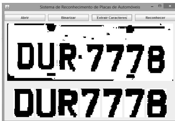
Figura 6. Resultado da segmentação de caracteres pelo algoritmo de análise de projeção
